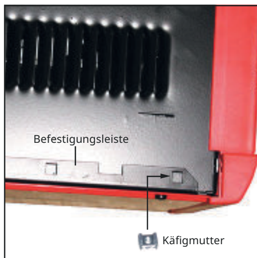
Detail Y - Ansicht: Käfigmuttern einsetzen
