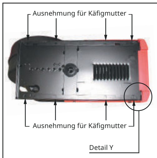
Ausnehmungen für Käfigmuttern an der Drahtvorschub-Unterseite
