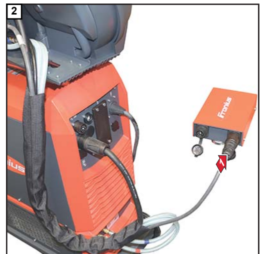
SpeedNet-Kabel vom Verbindungs-Schlauchpaket an der SpeedNet-Verteilerbox anstecken
