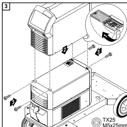
Apretar la refrigeración y la fuente de corriente en una consola vertical
