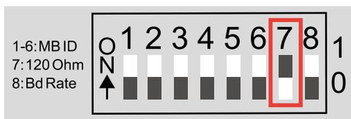
Active la resistencia de terminación de Fronius Smart Meter (R 120 Ohm) es-tableciendo el contacto 7 a ON (1).
