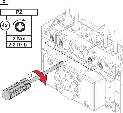
Βιδώστε σφιχτά το μονό καλώδιο (L1) και τον ουδέτερο αγωγό (N) στους ακροδέκτες σύνδεσης. Βιδώστε τους δύο ουδέτερους αγωγούς (N') στους ακροδέκτες σύνδεσης. Για τις εγκεκριμένες βίδες σύνδεσης και ροπές στρέψης βλ. [Εγκεκριμένες βίδες σύνδεσης](#) στη σελίδα [19](#).
