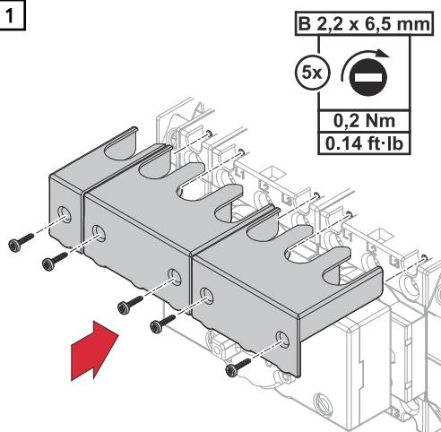
Τοποθετήστε από ένα προστατευτικό κάλυμμα στο επάνω μέρος σε όλους τους αποζεύκτες φορτίου 63 A. Για τη συναρμολόγηση χρησιμοποιήστε τις βίδες του παραδοτέου εξοπλισμού.
