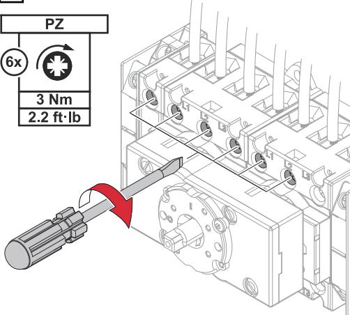
Βιδώστε οφιχτά τα μονά καλώδια (L1, L2, L3) και τον ουδέτερο αγωγό (N) στους ακροδέκτες σύνδεσης. Βιδώστε τους δύο ουδέτερους αγωγούς (N') στους ακροδέκτες σύνδεσης. Για τις εγκεκριμένες βίδες σύνδεσης και ροπές στρέψης βλ. [Εγκεκριμένες βίδες σύνδεσης](#) στη σελίδα [19](#).
