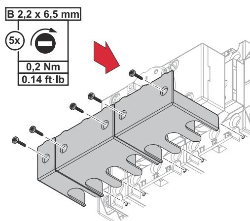
Τοποθετήστε από ένα προστατευτικό κάλυμμα στο κάτω μέρος σε όλους τους αποζεύκτες φορτίου 63 A. Για τη συναρμολόγηση χρησιμοποιήστε τις βίδες του παραδοτέου εξοπλισμού.
