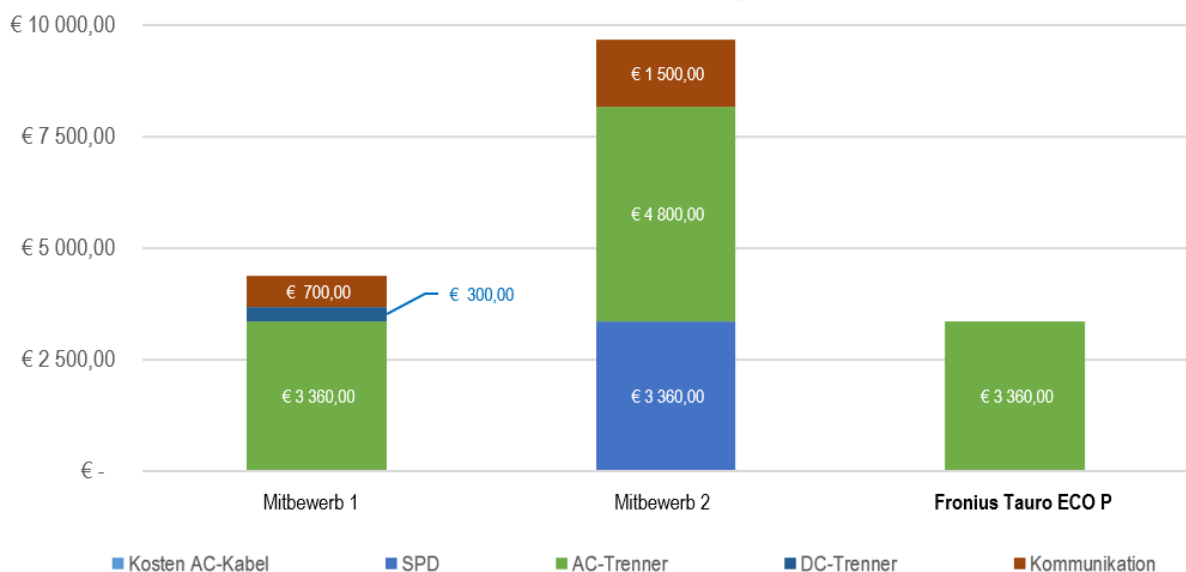
Abbildung 20: BOS-Kosten Vergleich eines Beispiels, 2400 kW AC, Freiflächen-Installation
